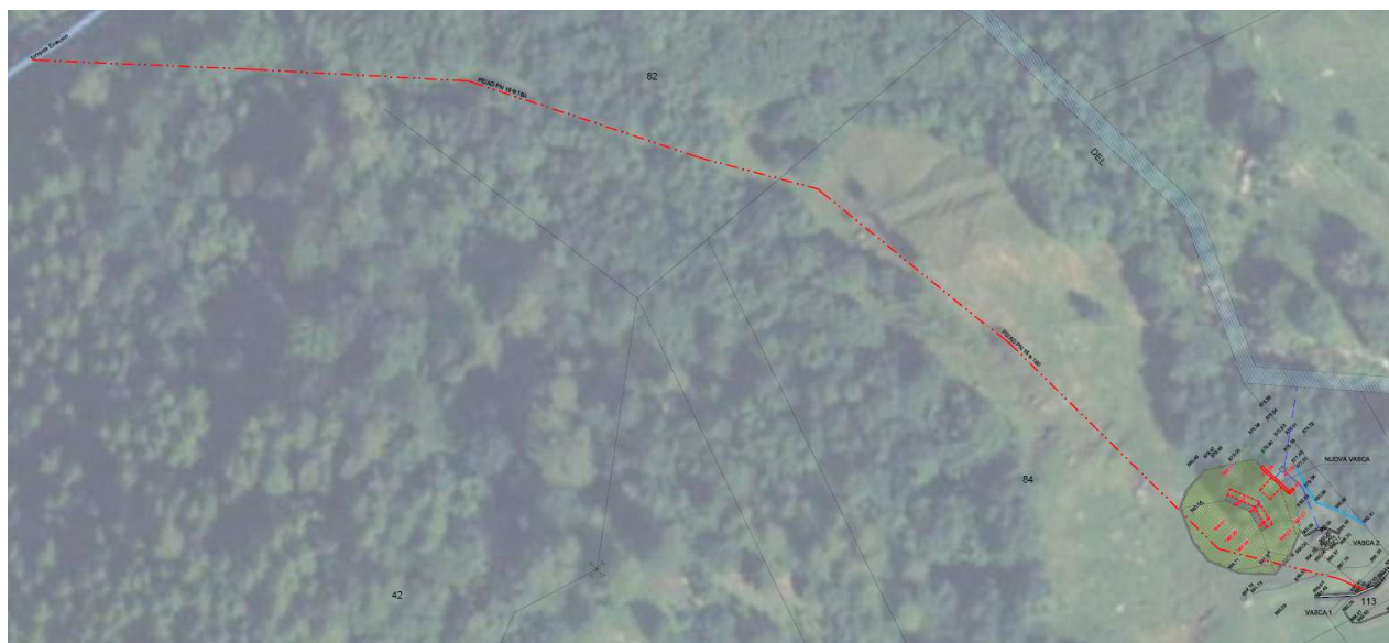
Tracciato nuova tubazione in PE/AD PN16 DN160
